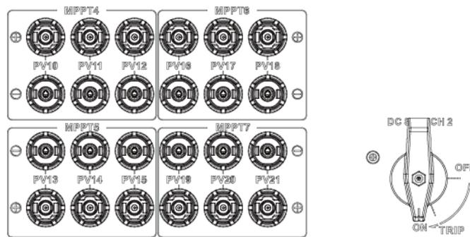
Si les bornes d'entrée CC ne sont pas entièrement configurées avec des chaînes PV, répartissez uniformément les chaînes PV d'entrée CC sur chaque MPPT. Pour de 8 à 20 chaînes PV, les bornes d'entrée CC suivantes sont recommandées.
