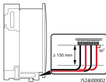
**Figure 5-15** Connexion des câbles d'alimentation d'entrée CC (AVIC JONHON)
