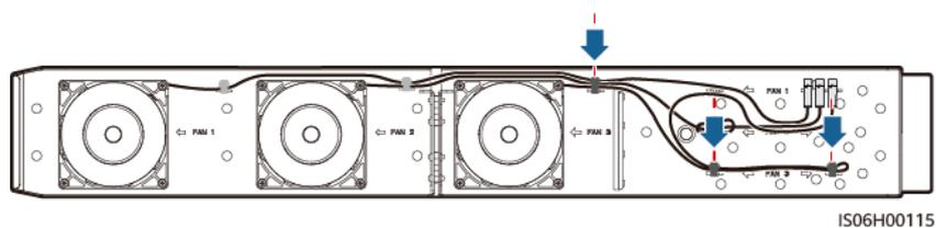
**Étape 8** Enfoncez le plateau du ventilateur jusqu'à ce que la plaque de déflecteur du ventilateur affleure le boîtier de l'onduleur.
