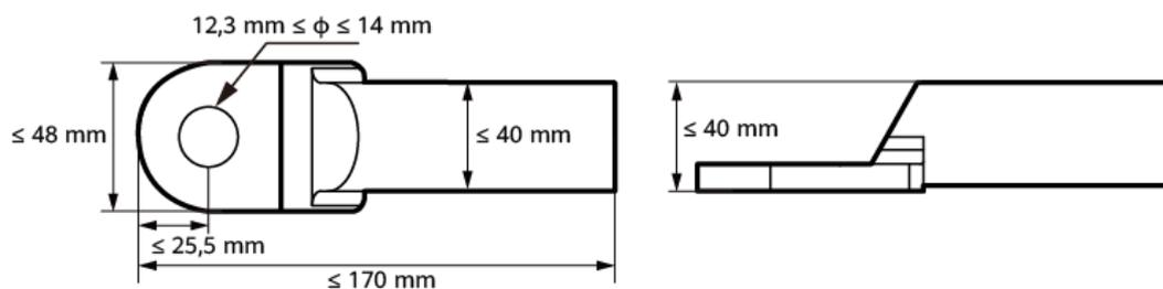
Figure 5-6 Connexion des câbles
