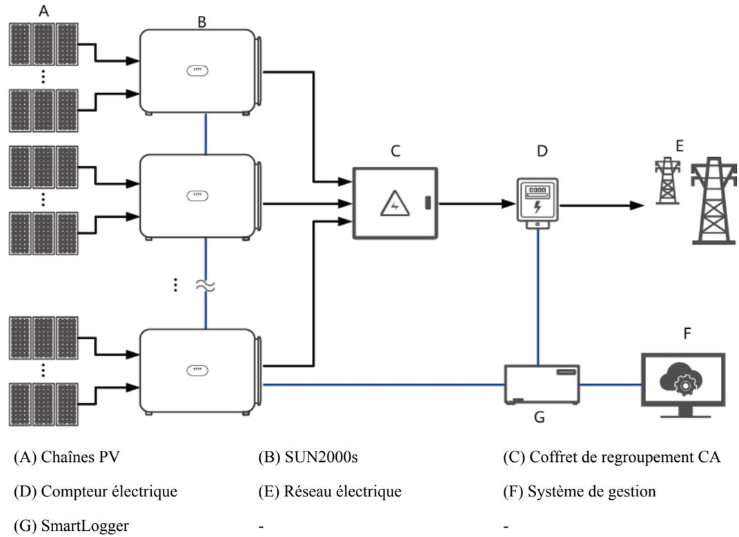
**Figure 2-3** Application de mise en réseau RS485 (Dongle)
