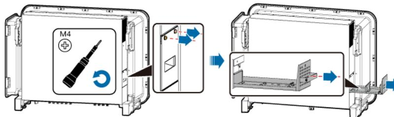
**Étape 2** Retirez les attaches de câbles partagées par les câbles, dévissez les connecteurs et débranchez les câbles.
