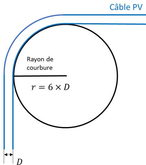
**Exemple :** Pour un câble d'un diamètre de 5,5 mm, le rayon de courbure minimal recommandé est de 33 mm.
