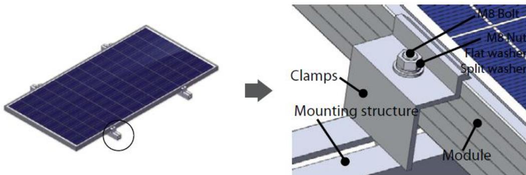
**NOTE :** Lors du montage, la surface de contact des pinces avec le cadre du panneau doit être au minimum de 70 %. Le couple de serrage spécifié par le fournisseur du système de fixation doit être respecté.
